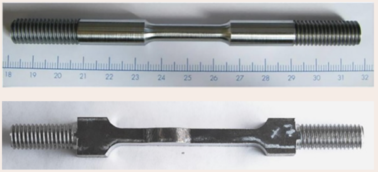
Figuur 2. Twee voor het onderzoek [2] gebruikte stalen proefstukken toegepast in de langzame trekproef in een 80 bar waterstofomgeving. Het bovenste proefstuk is zonder las en het onderste proefstuk is met las.
