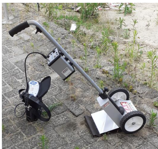
Figuur 7 Sensistor XRS 9012. Links de concentratie-indicatie met led lampjes. Hoe hoger de concentratie, des te meer lampjes gaan branden Rechts met bijbehorende sleepmat 8612.
