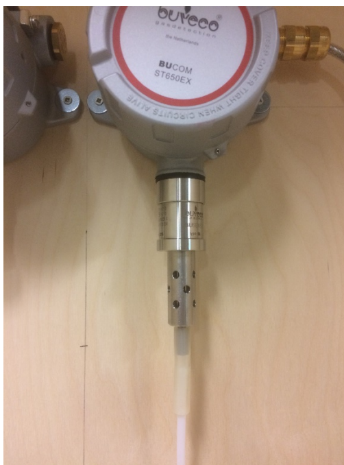
Foto's van de LEL-sensoren met kalibratie adapteropzet.
