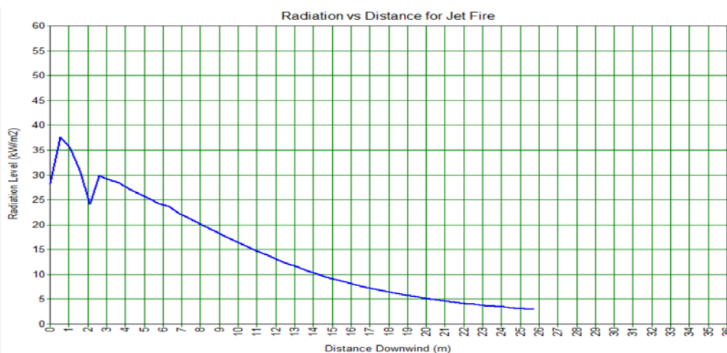
Figuur 6: Warmtestraling tegen afstand voor een waterstofleiding, 8 bar, 110 mm.
