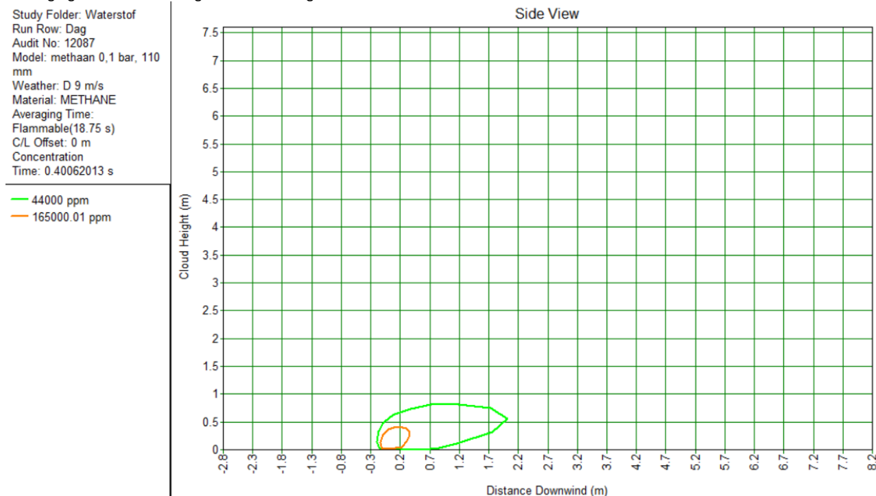
Figuur 12: Wolk van aardgas bij een breuk van een 100 mbar, 110 mm leiding. De buitenste kring is de LFL, de binnenste kring de UFL.
