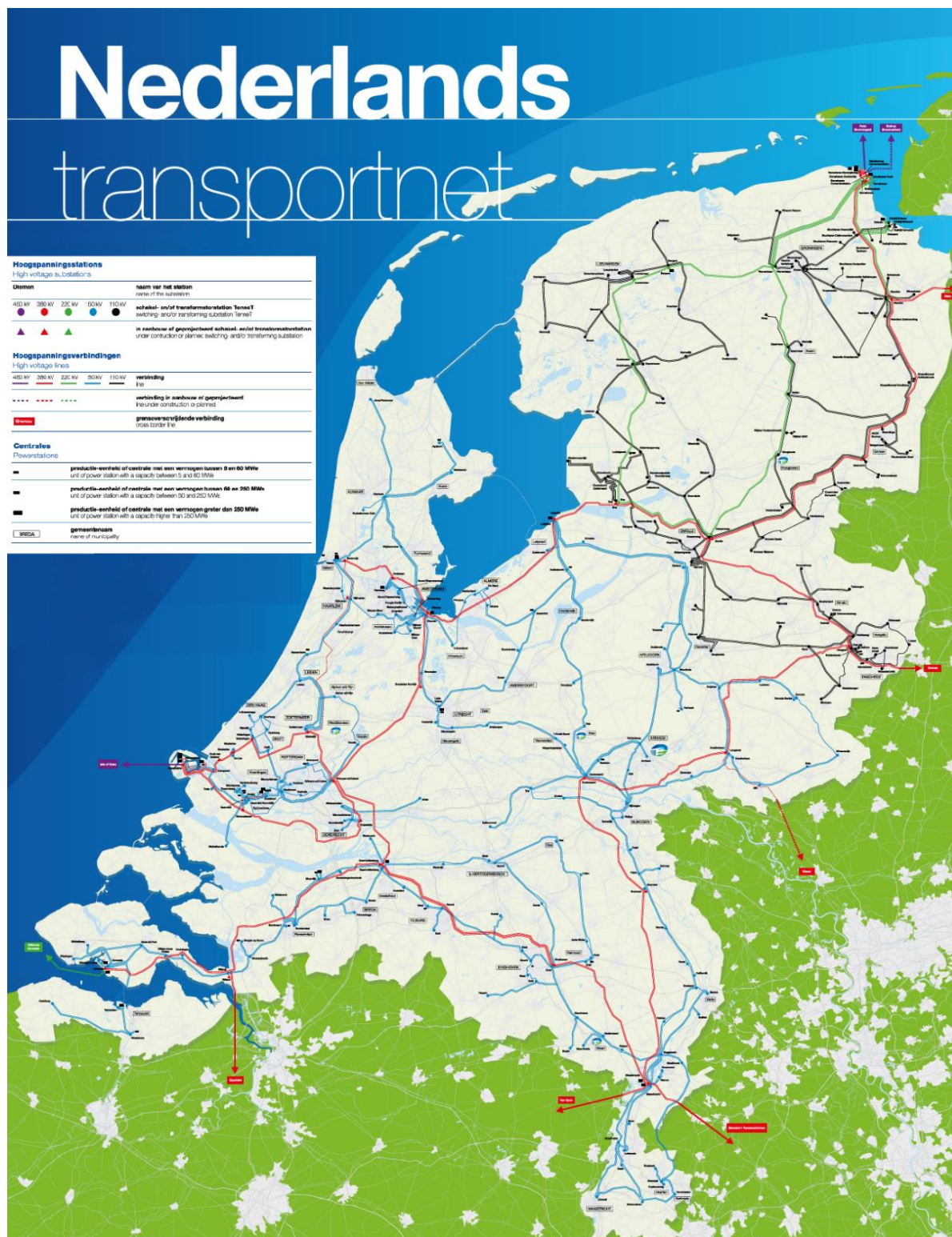
Figuur 2.1 Overzicht van het (extra) hoogspanningsnet [1].
