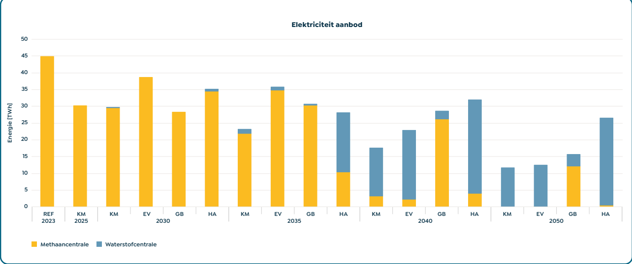
Figuur 4.6.14 Totale elektriciteitsproductie uit gasgestookte productie-installaties.
