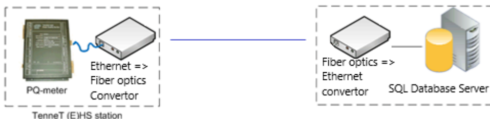
Figuur 5.1b: Principeschema glasvezel dataaansluiting PQ meters (E)HS systeem
