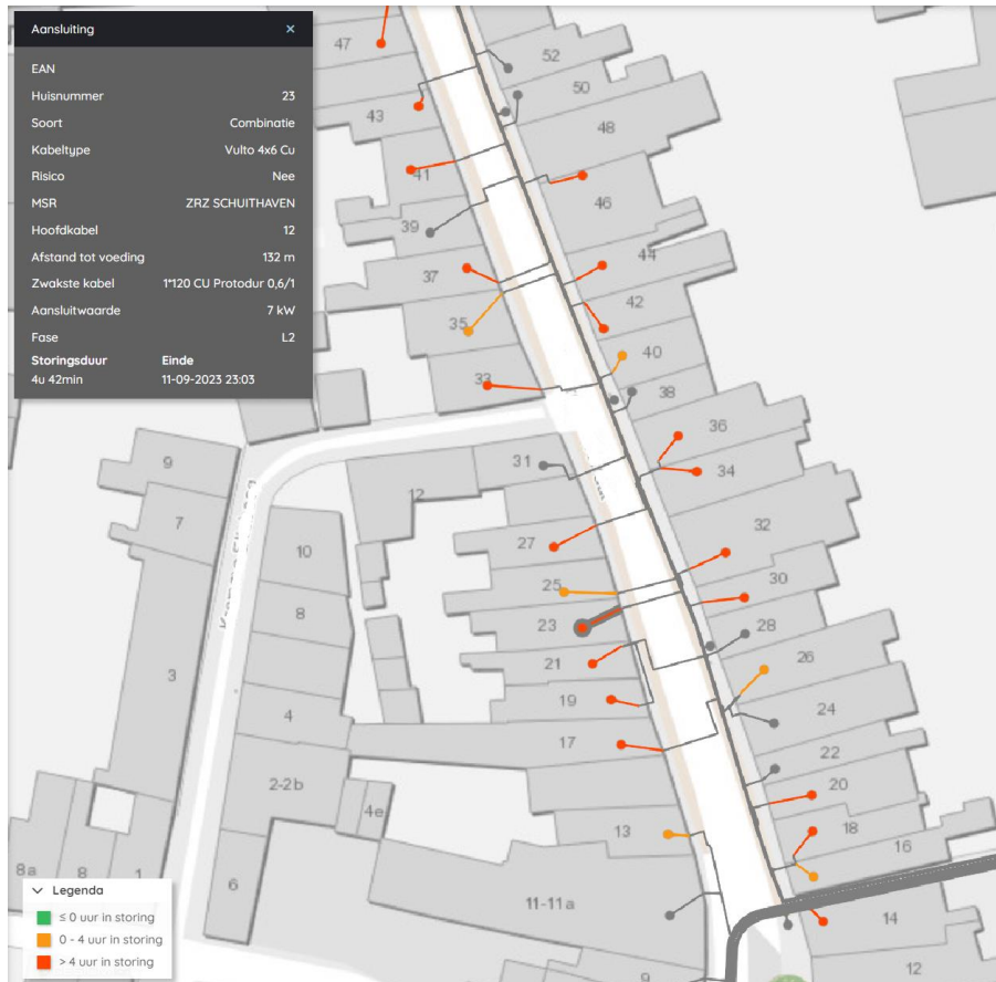
Figuur 3 - Voorbeeld van een straat met een aansluiting die een storing heeft gehad op 11 september met een duur van 4 uur en 42 minuten.
