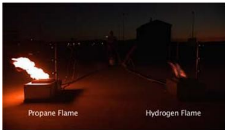
Figuur 1: de verbranding van propaan en waterstof in een nachtelijke opname
