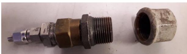
Figuur 6: Gebruikte fitkoppeling (teflontape ontbreekt op foto). Op de overige verbindingen is locktight toegepast.
