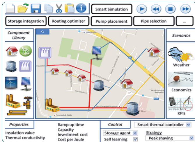
Figuur 1: Artist impression van de gebruikersinterface. Middels drag&drop wordt met componenten uit de library (links) eenvoudig een nieuw hybride energiesysteem gecreëerd, of een bestaand systeem aangepast. Linksonder worden componenten gedimensioneerd, rechtsonder wordt regeltechniek geselecteerd. Rechts in de interface worden externe factoren ingeladen. Op termijn wordt koppeling met GIS voorzien en komen modules (boven) beschikbaar voor geautomatiseerde ontwerptimalisatie.
